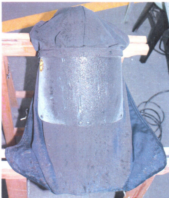
Foto N° 5: Muestra 16.025-03 después del ensayo de arco eléctrico
