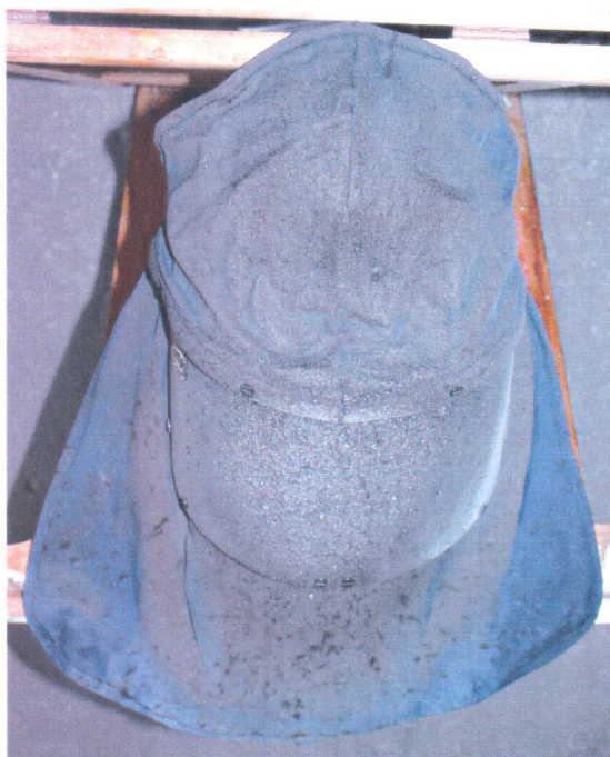
Foto N° 3: Muestra 16.025-02 después del ensayo de arco eléctrico
