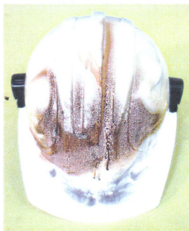
Foto N° 6: Casco de la Muestra 16.025-03 después del ensayo de arco eléctrico
