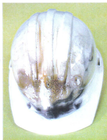
Foto N° 4: Casco de la Muestra 16.025-02 después del ensayo de arco eléctrico
